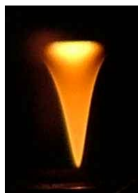
Рис. 5: Фотография зоны реакции моносилана с излучением CO_2 -лазера.
